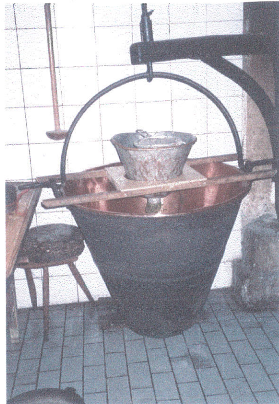
Abbildung 4: Käsekessel mit Milchfiltervorrichtung (BIETZKER, 2001)
